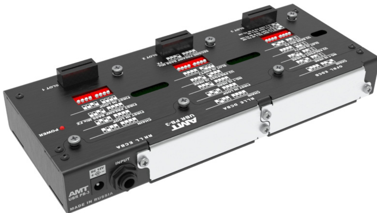
Рис. 1 — Внешний вид педалборда PB-3 (без установленных AMT TC-3M)
